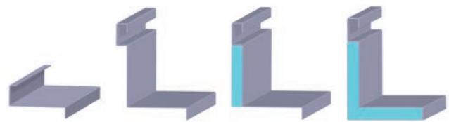
LB = niedriger Montagefuß HB = hoher Montagefuß GHB = Isolierter hoher Montagefuß GHB mit Flanschisolierung
